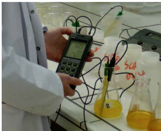
Buckman nv : pH meting met HI 9126 in het labo
